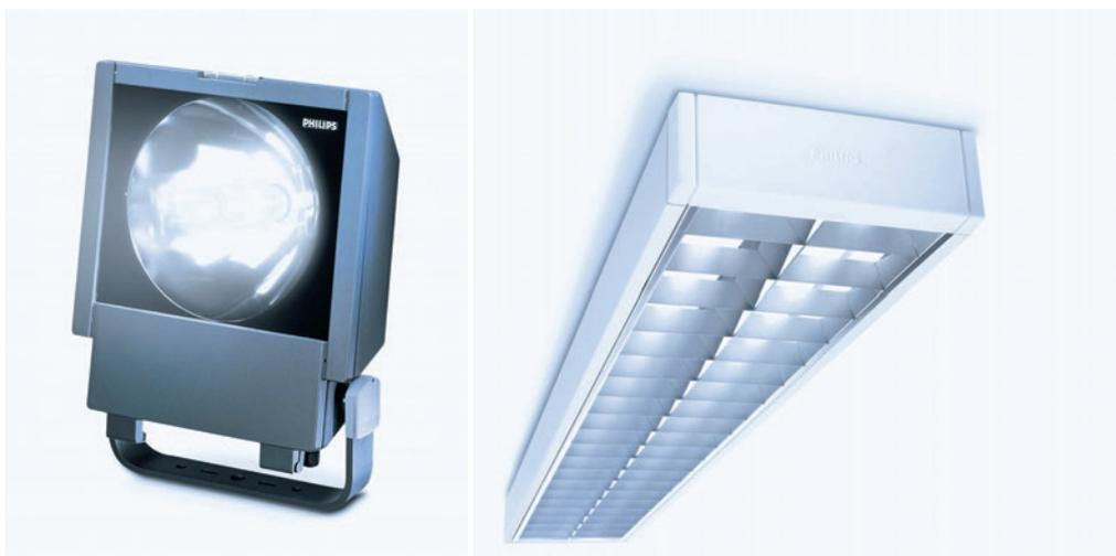
Fig. 2 – Apparecchi per illuminazione: nel proiettore da esterno a sinistra è ben visibile la parabola riflettente posta dietro la sorgente primaria (lampada); nella plafoniera per interni, a destra, si distingue lo schermo a lamelle per la riduzione dell'abbagliamento. (Philips Lighting Italy)
