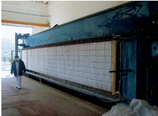
Fig. 24 – Disinquinamento. Filtropressa per la concentrazione dei fanghi provenienti da un depuratore di acque reflue. (Paolo Fioretti)
