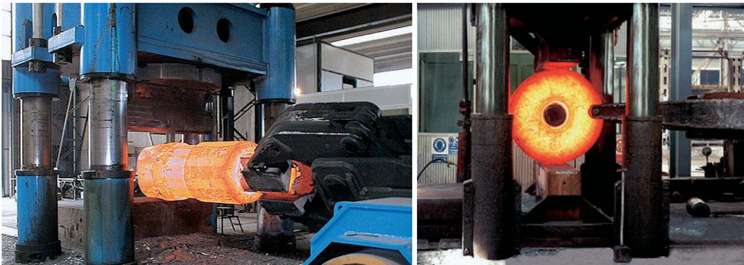
Fig. 27 – Fucinatura. Fucinatura di grandi alberi di trasmissione e anelli per macchinari mediante pressa da 4000 T (Forgiatura Mamé Spa).
