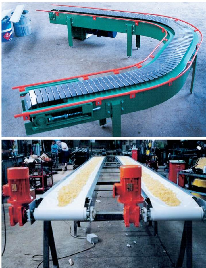
Fig. 1 – Apparecchi di trasporto. Sopra, trasportatore a piastre snodate; sotto, trasportatore a nastro flessibile (MFG Snc)
