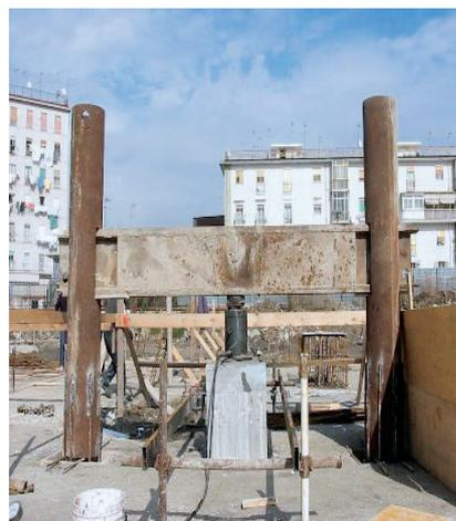
Fig. 34 – Prove di carico. Prova di carico su palo condotta a mezzo di un martinetto posto in contrasto con una trave metallica collegata a due pali adiacenti sollecitati a trazione (Trivel CAV Srl)
