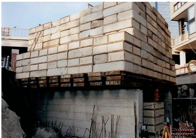
Fig. 35 – Prove di carico. Prova di carico su palo condotta a mezzo di martinetti collegati a travi metalliche caricate con zavorre in calcestruzzo di peso prestabilito (Trivel CAV Srl).
